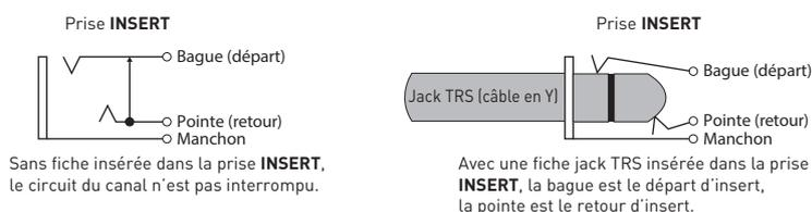
Activez le point d'insertion avec les touches **INSERT/AIR** [6] de la face avant (sélectionnez d'abord **INSERT** à l'aide du commutateur général [8]). Le voyant du canal s'allume en vert pour confirmer la sélection.
